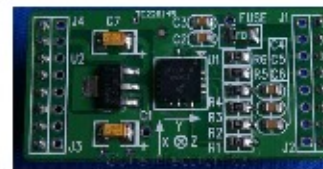
Gambar 2.3 Penampang atas sensor Accelerometer
